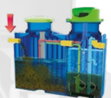
FAZA V – ODPROWADZANIE NADMIARU OSADU
