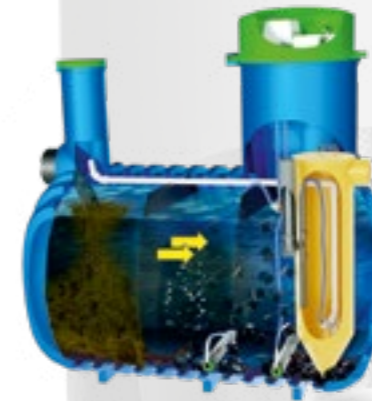
FAZA II – NAPOWIETRZANIE W 1 REAKTORZE BIOLOGICZNYM
